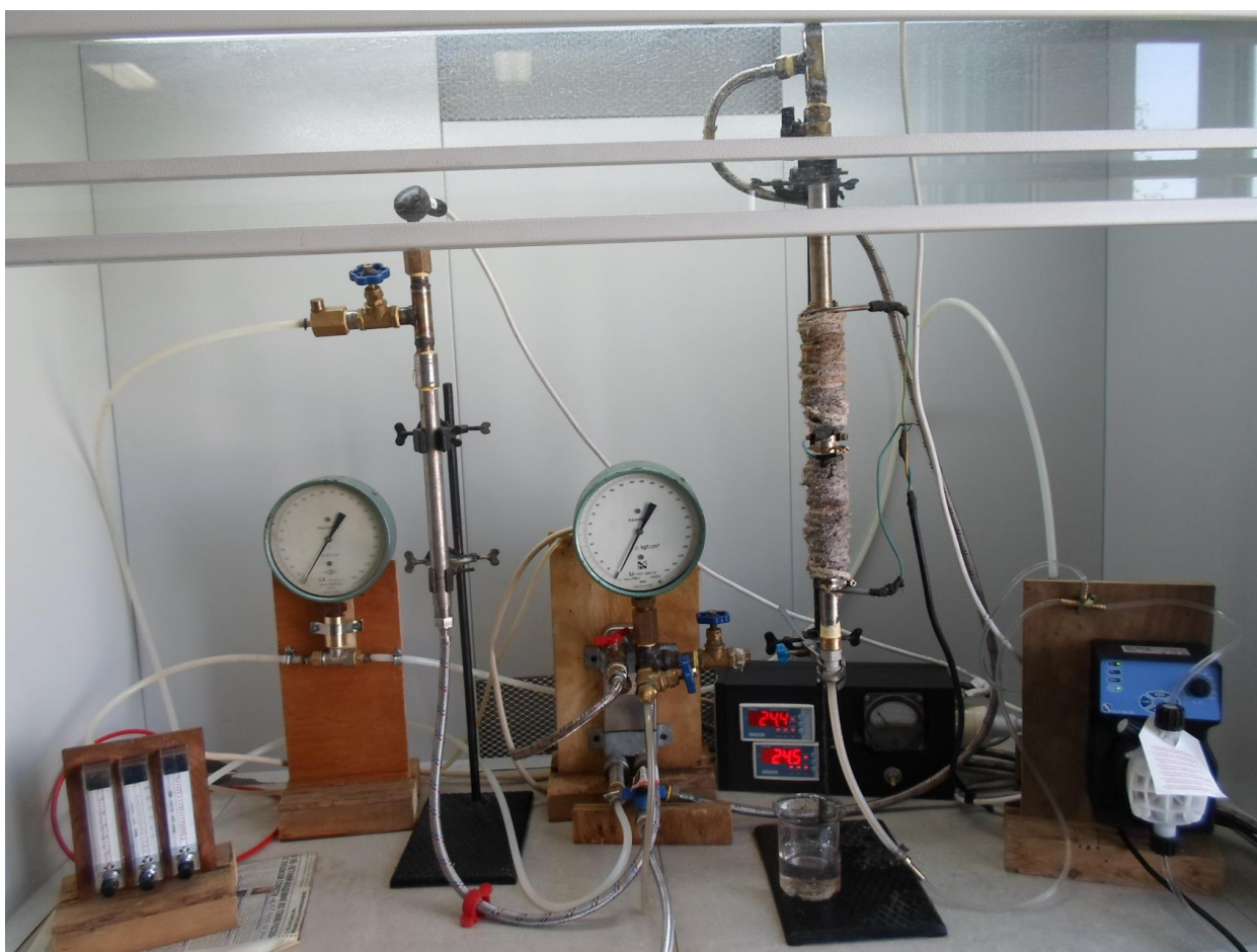
Сурет – Фенолдарды тотықтыруға арналған 2 аймақтық сүзгі реакторының зертханалық қондырғысы
